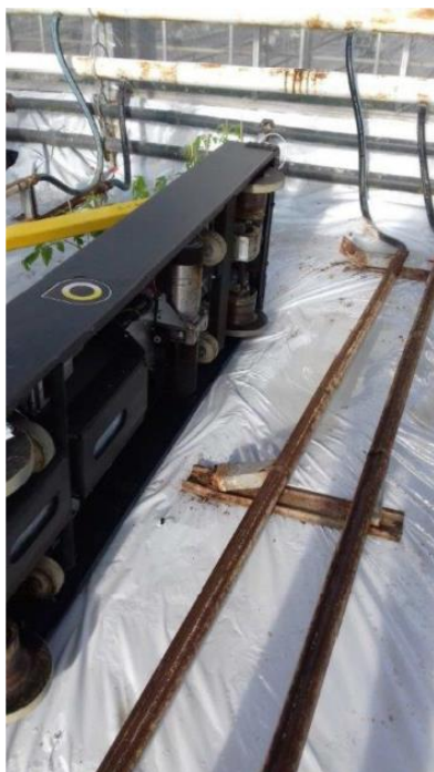
Figure 1 : un système de chauffage utilisé comme rail
