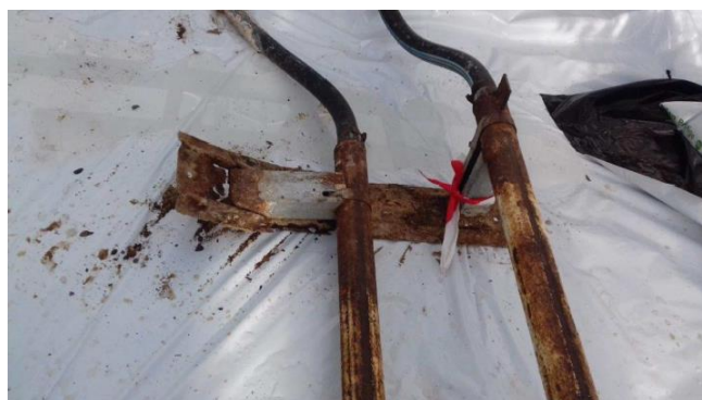
Figure 1 : un système de chauffage utilisé comme rail
